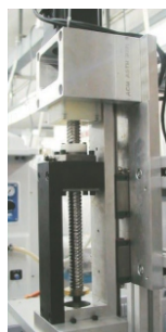
Recorrido del tampón accionado por un servomotor
